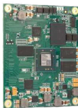
Процессорный модуль ЦИНК-20
